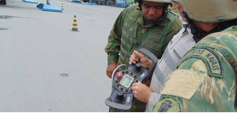
Figura 5: Operador de guindaste do porto realizando demonstração de operação por meio de dispositivo remoto.
