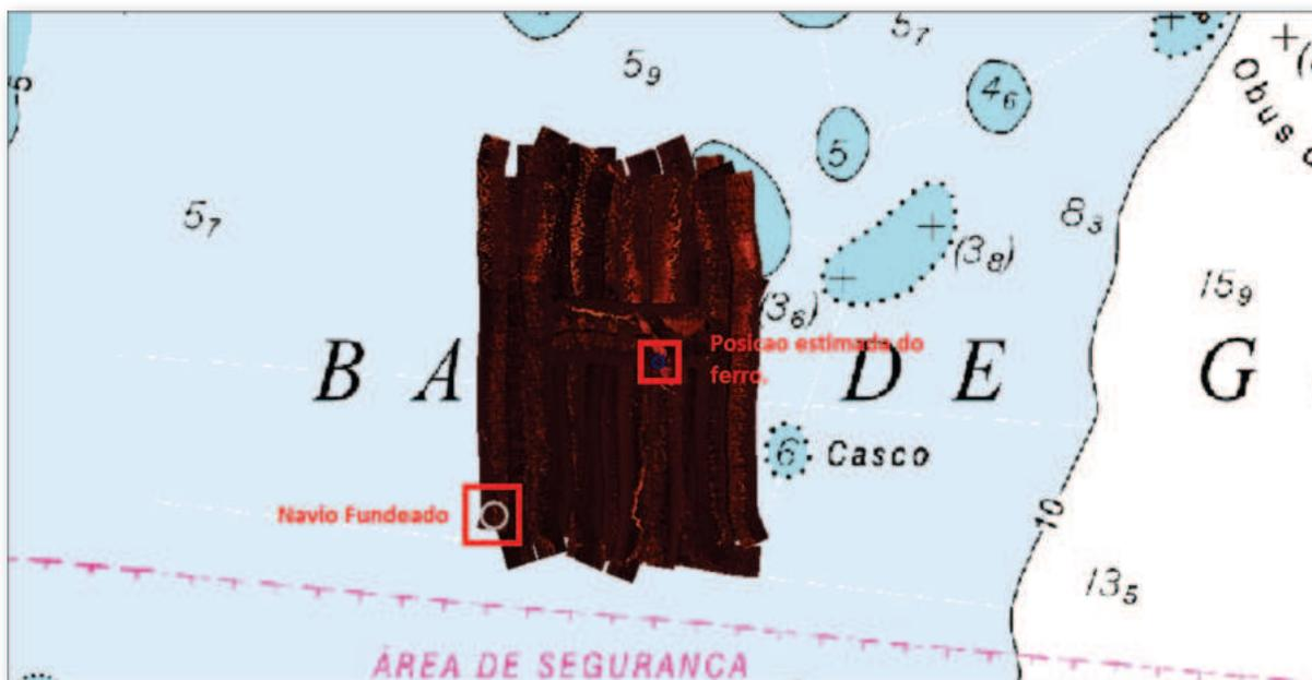
Área onde foi efetuada a varredura visualizada com auxílio do Software Chesapeake SonarWiz5, demarcando-se a posição estimada de contatos
