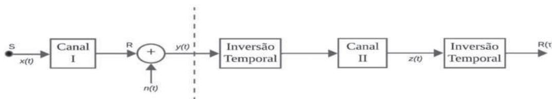
Figura 1 – Diagrama de Localização com TRM e um único sensor. Fonte: Elaboração própria
