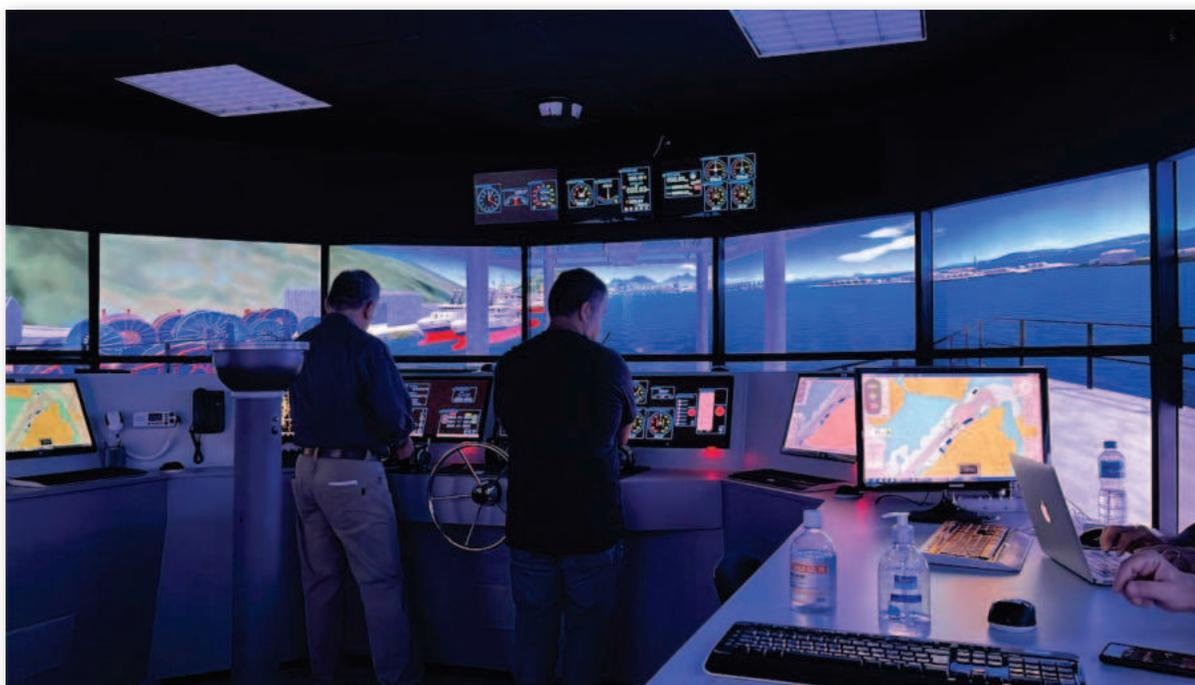
Figura 5 – Exemplo de um simulador do tipo “Full Mission”, da Universidade de São Paulo. Fonte: elaboração própria, 2023 - simulação de manobras no Terminal BANIT, na Ilha da Conceição Niterói-RJ
