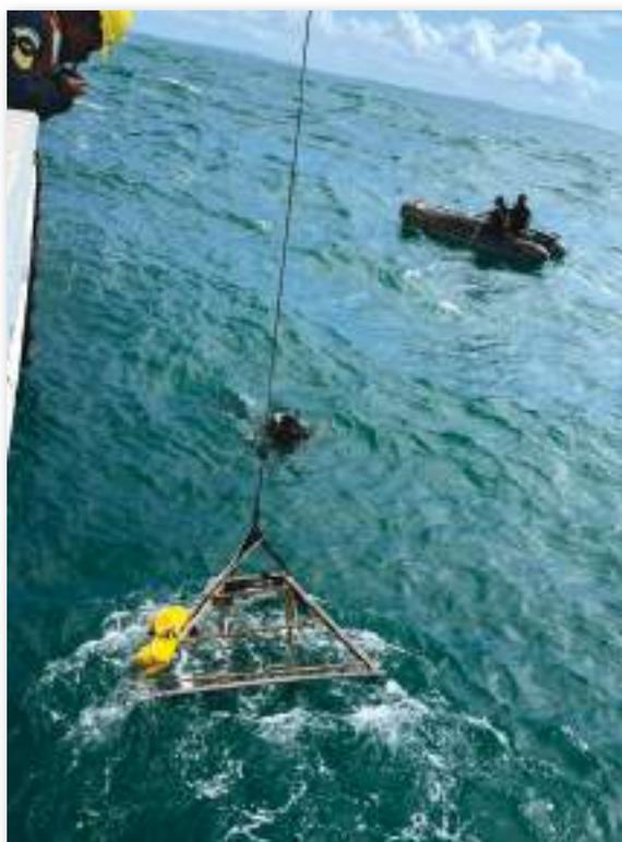
Instalação do Sensor de Pressão
