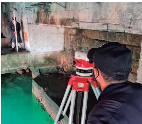
Figura 3 – Nivelamento geométrico da régua maregráfica do Porto de Imbituba
