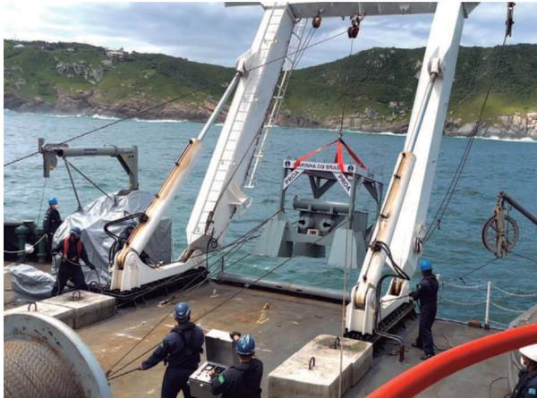
Figura 2 – Fundeio de estação subaquática, para mapeamento de raia acústica
